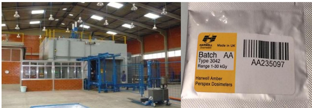
Figura 2. Irradiador multipropósito (imagem à esquerda) do Centro de Tecnologia das Radiações (IPEN/CNEN/USP) e Dosímetro Gammachrome YR Batch 530 nm (imagem à direita). Fonte: IPEN (2019). Fonte: IPEN (2019).
