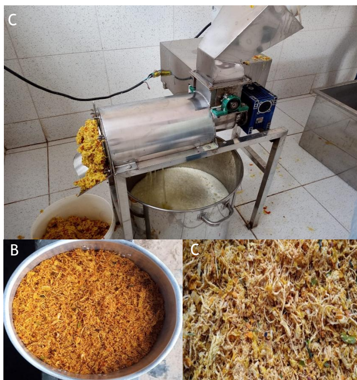
Figura 4. Produção na fábrica de cajuína do Assentamento Córrego do Murici em Beberibe-CE. Aspecto do suco integral e do bagaço do pedúnculo do caju após primeira prensagem (A), empregando-se prensa expeller e Fibra natural (B) e saborizada (C) do pedúnculo do caju processada.
