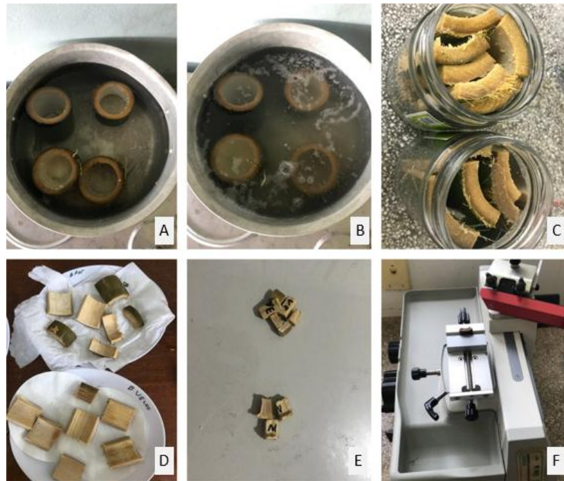
Figura 2. Imagens de de Guadua aff. Lynncarkiae . Legenda: A) fragmentos do colmo do bambu antes do molho; B) depois do molho; C) fragmentação e acondicionamento em potes de vidro com álcool 70% para cozimento em autoclave; D) padronização do comprimento do comprimento; E) padronização da largura; F) Micrótopo de deslizamento utilizado para os cortes anatômicos.
